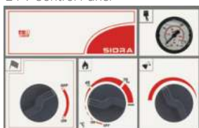
Quadro Elettrico 24 V 24 V Control Panel
